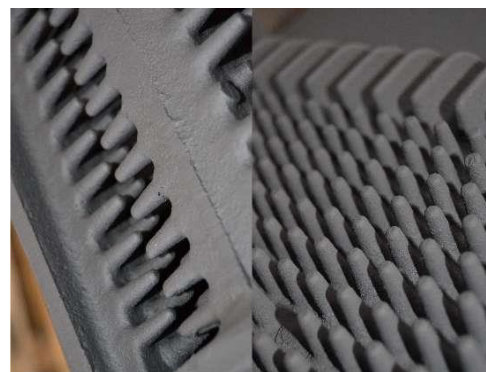
Рисунок 1. Внешний вид поверхностей теплообменника
